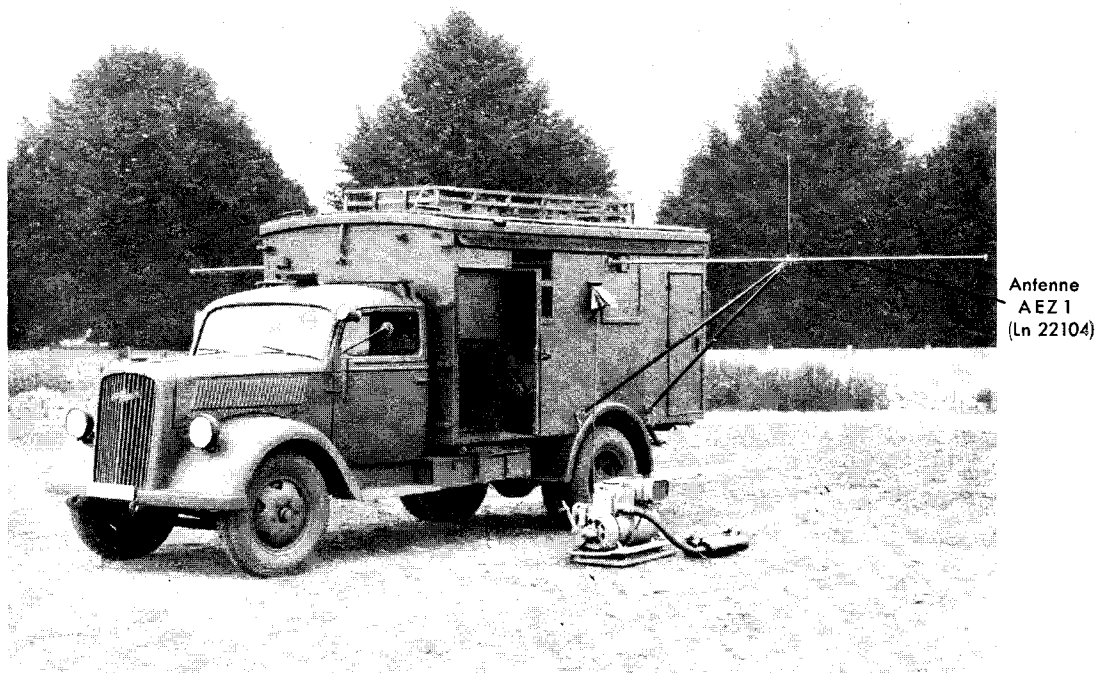
Abb. 11. Der fahrbare EZ-Sender, betriebsbereit
